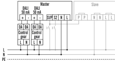
*Raccordement maître/esclave avec commande optionnelle par poussoirs. Un appareil maître peut être raccordé à 10 appareils esclaves au maximum.*
