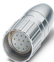
M23, Connecteurs à câble, droit, blindé: non, Verrouillage à vis, Nombre de pôles: 12, Sens de rotation: inversé, type de contact: Connecteur femelle, Cône de soudage, plage de diamètre de câble: 6,5 mm ... 7,5 mm, détrompage: N
