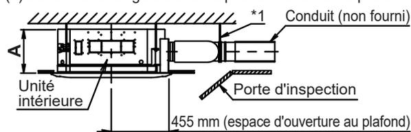
\*1. Suspendez et fixez l'ensemble de tube en T à installer. La charge de l'ensemble du tube en T peut créer un espace entre l'unité intérieure et la chambre d'aspiration.
