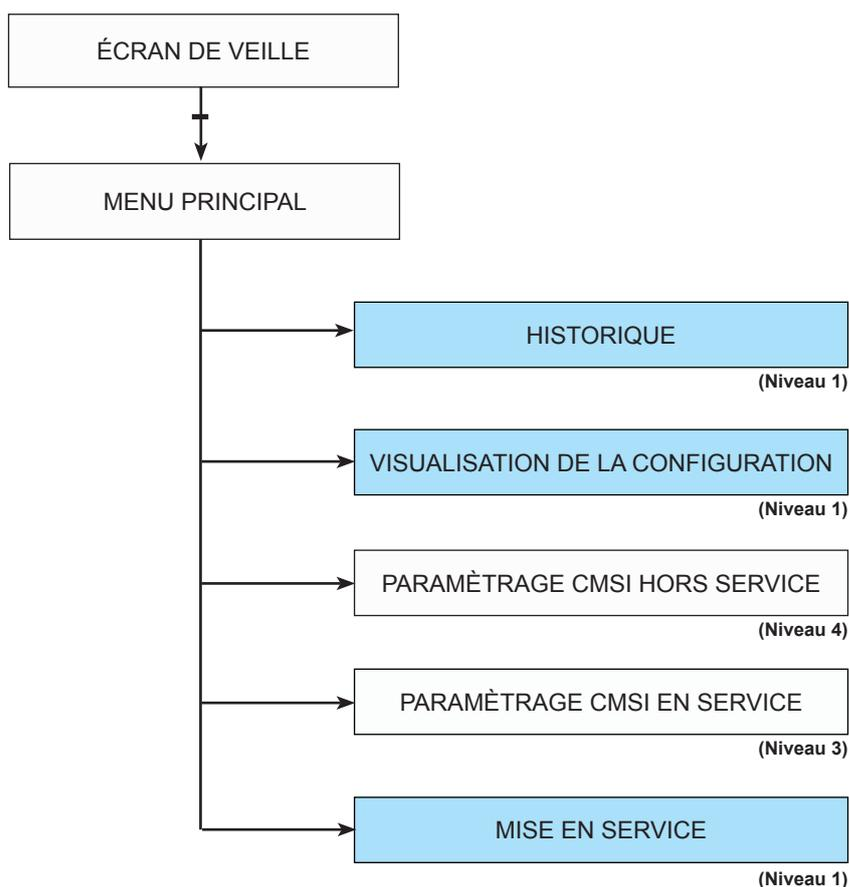
Les MENUS de niveaux 1 ou 3 peuvent être utilisés par l'exploitant pour vérifier :
