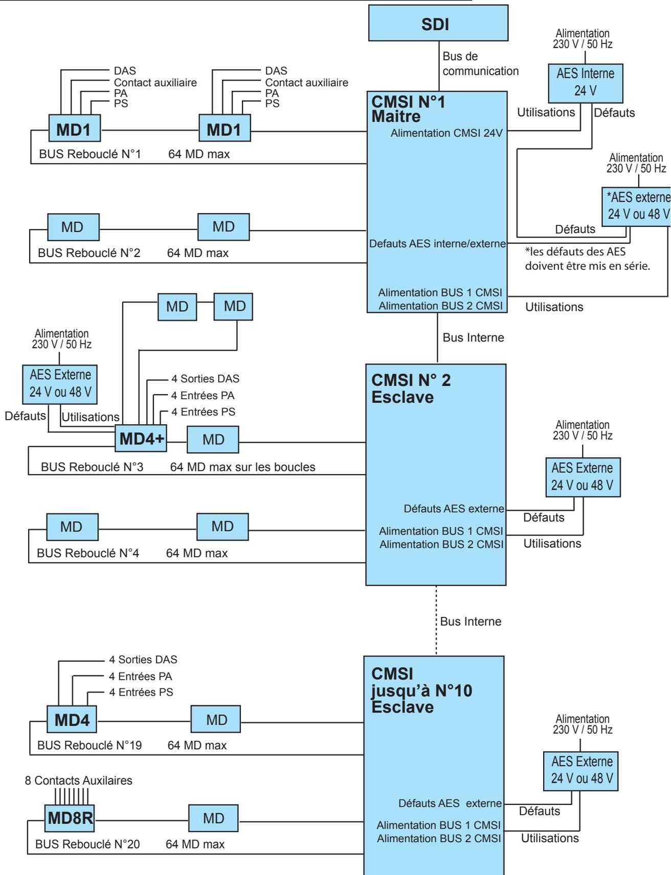
Le bus rebouclé est constitué des voies de transmission et des lignes d'alimentation.
