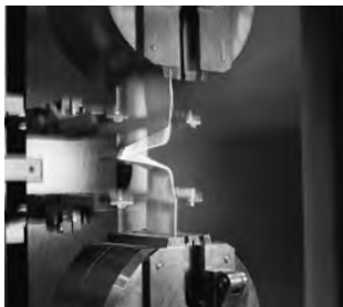
Fig. 2: Folde- og strekkforsøk i kvalitetskontrollen til RHEINZINK
