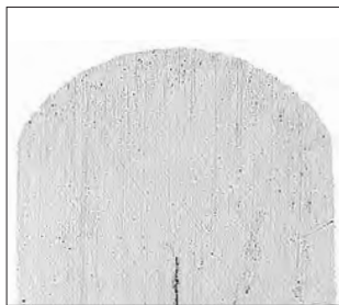
Fig. 3: Tverrsnitt av en bøyeprobe etter 180° folding, uten mellomsjikt, parallelt med valseretningen
