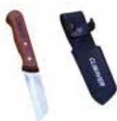
Kniv for kutting av kanalplater i to deler og andre operasjoner som f.eks. å skjære ut kantklaffer. Både skarp og butt side benyttes til det formål.
