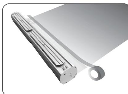
**8)** Applicare una striscia di nastro adesivo trasparente per aumentare la tenuta della stampa (possibilmente altezza 5 cm) a cavallo tra la stampa e la linguetta di fissaggio. N.B. Il nastro non sarà visibile quando l'espositore sarà installato.
