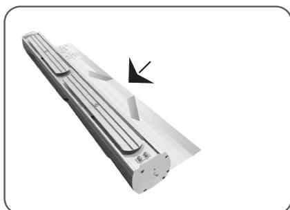
**3)** Rimuovere SOLO LA PARTE CENTRALE della protezione del biadesivo presente sulla linguetta di fissaggio dell'espositore.
