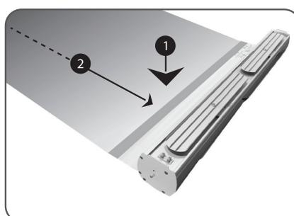
**10)** Gestire la pressione esercitata sul punto 1 della figura per permettere il progressivo arrotolamento del telo all'interno della struttura.
