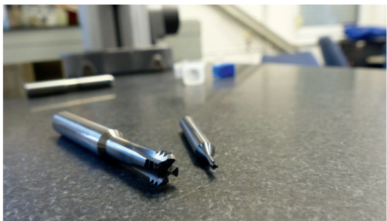
Standzeiten bis zu 50 Stunden: Bei Wisoma setzt man beim Gewindefräsen ausschließlich auf OSG – von M4 bis M12. (© OSG)
