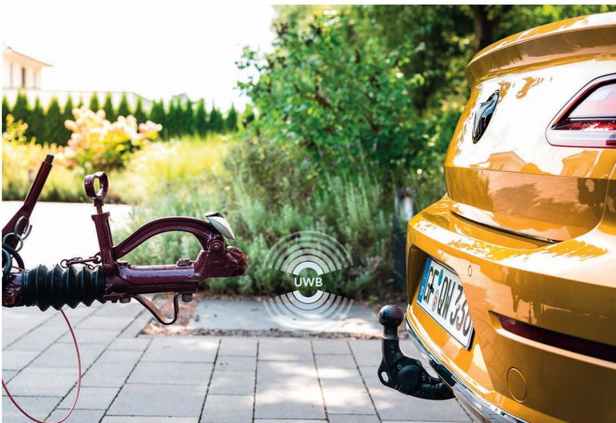
**Bild 2: Anwendungsszenario Automatisierte Anhängerkupplung: Auto und Anhänger verbinden sich automatisch. (© Volkswagen)**
