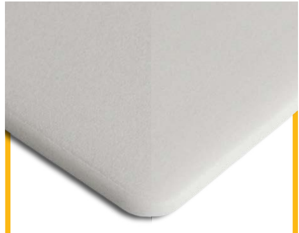
Trowalisiert 20 Minuten / 4 Stunden Selektives Lasersintern
