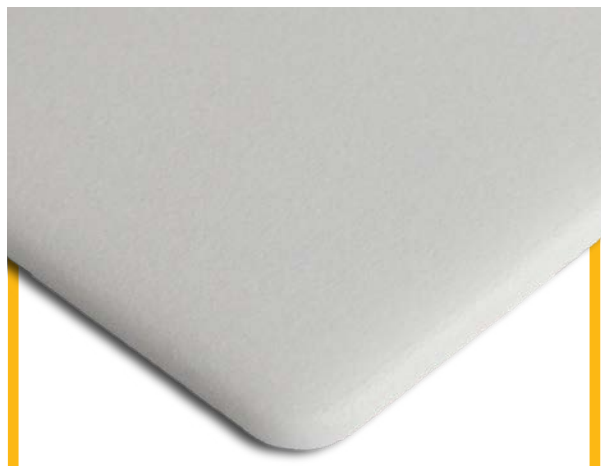
Epoxy versiegelt Selektives Lasersintern
