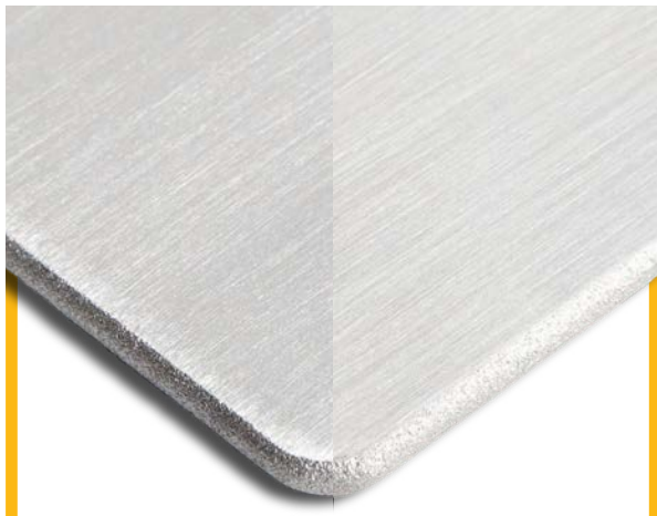
Schleifpapier Körnung 240 / 1.000 Laserschmelzen Aluminium
