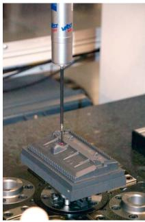
**Der Nullpunkt bleibt:** Das Bild zeigt die fertig gefräste Elektrode auf der CNC-Koordinatenmessmaschine von Zeiss. (Bild: Mecadat)
