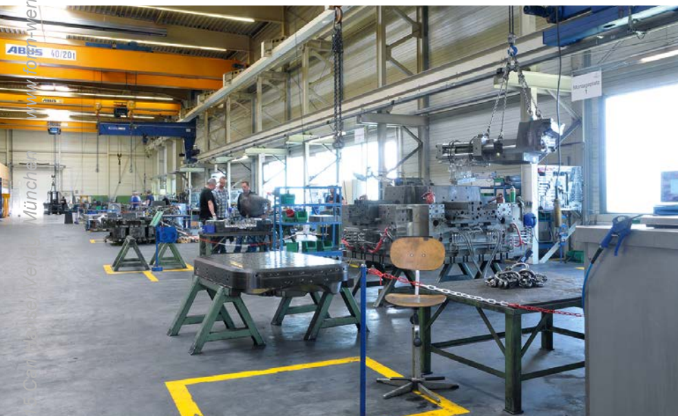
Montageplätze mit standardisiertem Layout: Nur Teile, die in einem definierten Zeitraum verbaut werden, kommen in die Zellen. (Bild: Schaufler Tooling)
