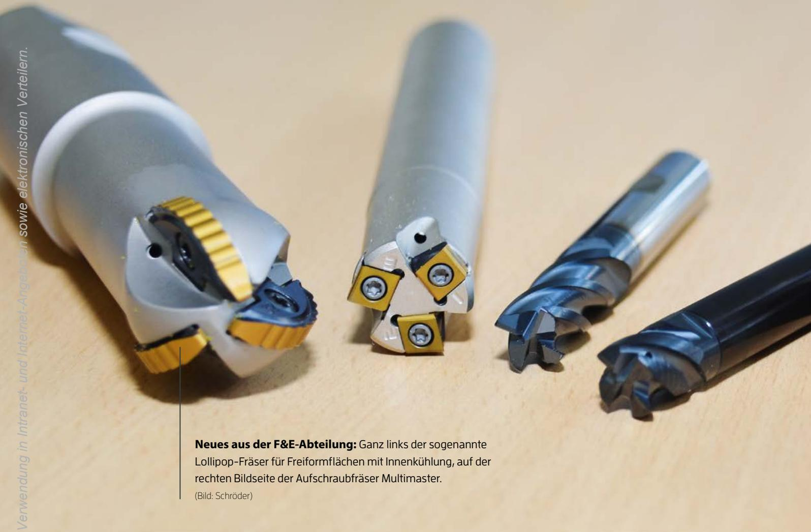
**Neues aus der F&E-Abteilung:** Ganz links der sogenannte Lollipop-Fräser für Freiformflächen mit Innenkühlung, auf der rechten Bildseite der Aufschraubfräser Multimaster.
