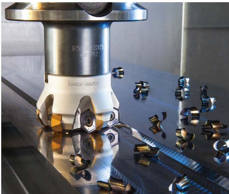
**Moderate Geschwindigkeiten:** Der Helido ist Iscars Antwort aufs Planfräsen. (Bild: Iscar)
