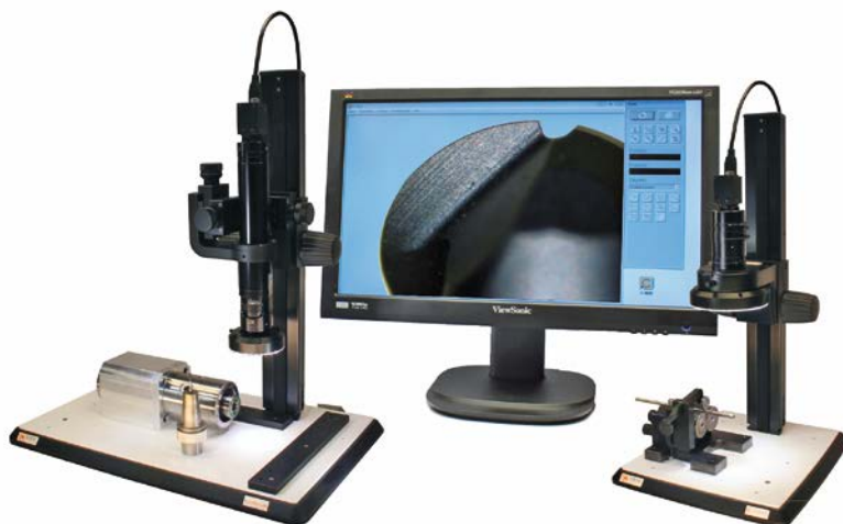
Fräser unter der Lupe: Kontur und Oberfläche der Werkzeuge wurden optisch mit C-View von Cimtrode überprüft. (© Zecha)
