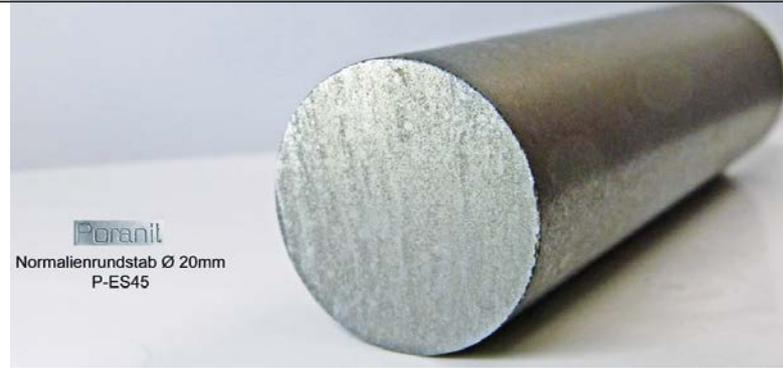
**Normalien-Rundstab aus P-ES45:** Der Werkstoff wird aus einem Chromstahlgranulat hergestellt und ist daher rostfrei. (© Bioenergie)
