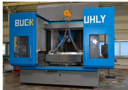
**Tiefbohren bis 2 m Länge:** Lohndienstleistung ist das zweite wichtige Standbein von Buck Formenbau. Zum Schrumpfen und Tiefbohren kommt die BuckUhly TBFZ-G 2000 zum Einsatz. (© BuckUhly)
