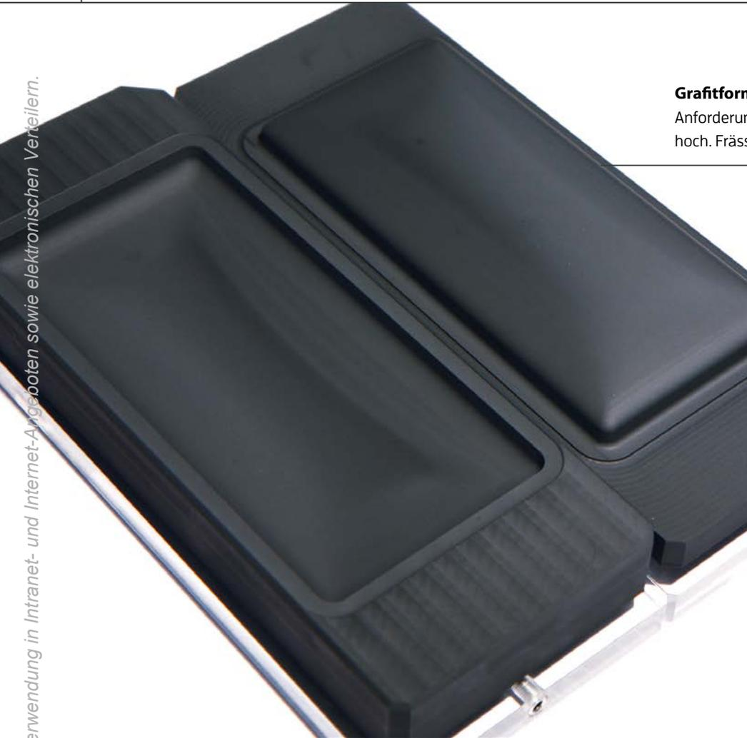
**Grafitform für ein Mobiltelefongehäuse:** Die Anforderungen an Präzision und Oberflächenqualität sind hoch. Frässpuren sind tabu. (© GF Machining Solutions)
