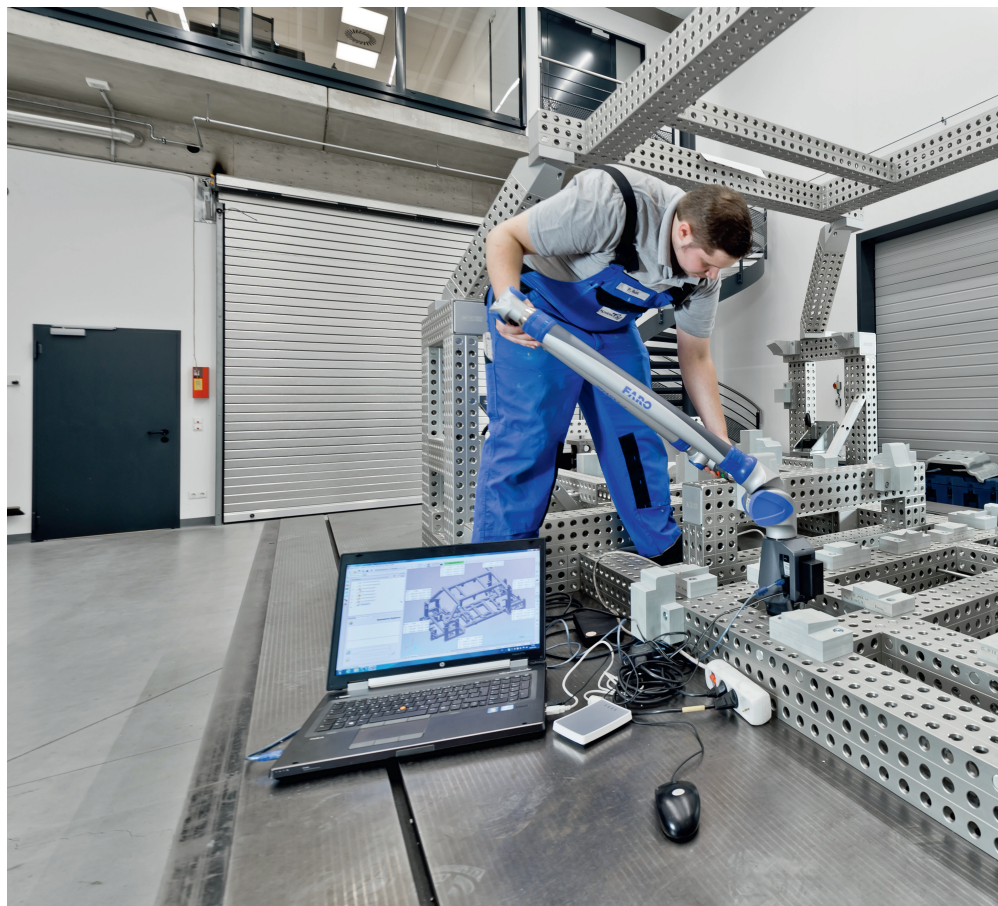
Hohe Flexibilität: FaroArm plus Laptop ergeben eine mobile Messstation. So können beliebige Punkte gemessen werden. (© Autodesk/Schäfer)
