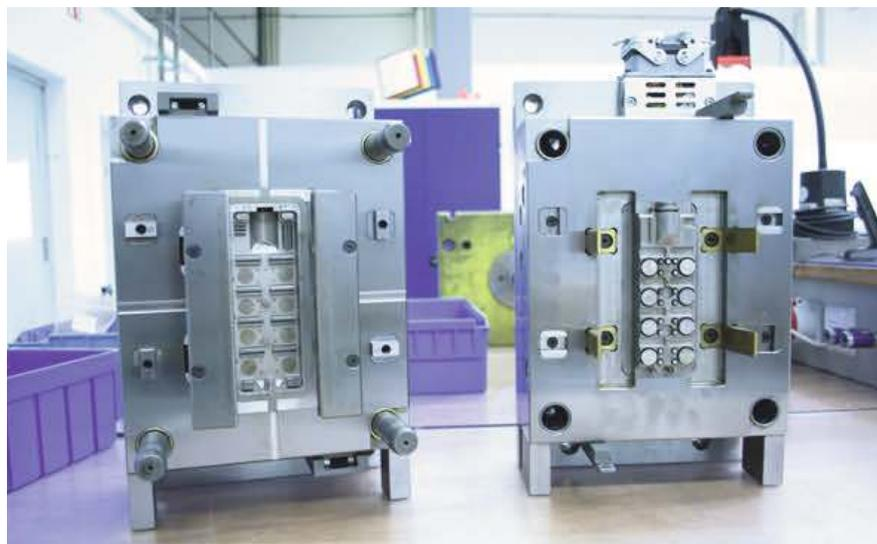
**Variantenreich:** Der Formaufbau ist standardisiert und wird für unterschiedliche Varianten eines Artikels genutzt. Dazu müssen lediglich die Formeinsätze ausgetauscht werden.
