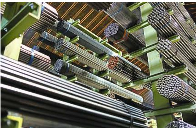
**Hochfest:** Die ETG- und HSX-Stähle bringen über den ganzen Querschnitt und Abmessungsbereich gleichmäßige mechanische Eigenschaften mit.
