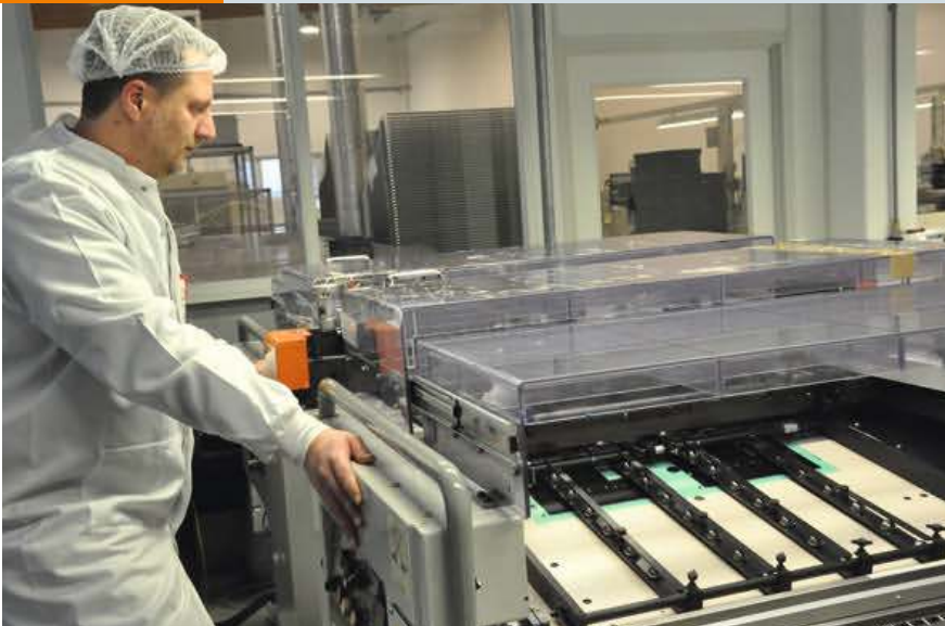
Im Reinraum: Die dekorativen Schichten werden im Siebdruckverfahren auf die Folie aufgebracht – in Reinräumen nach ISO-Standard.
