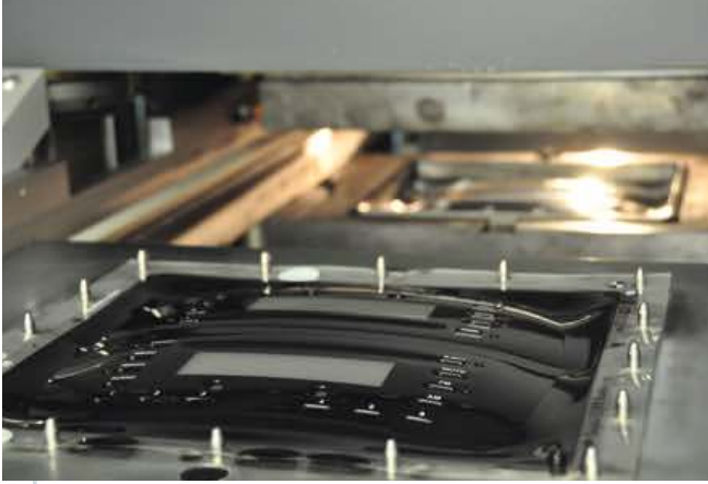
Mit Hochdruck: Werkzeug für die dreidimensionale Verformung der Folie. Der Luftdruck liegt dabei zwischen 150 und 300 bar.
