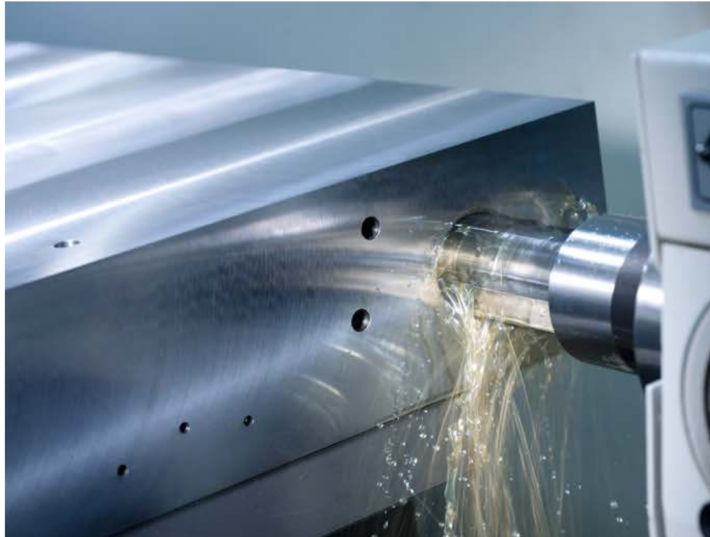
Tieflochbohren: Aufgrund der feinen Karbidstruktur bei Corroplast FM ist gewährleistet, dass auch bei filigranen Bohrungen mit hoher Schnittgeschwindigkeit gearbeitet werden kann.
