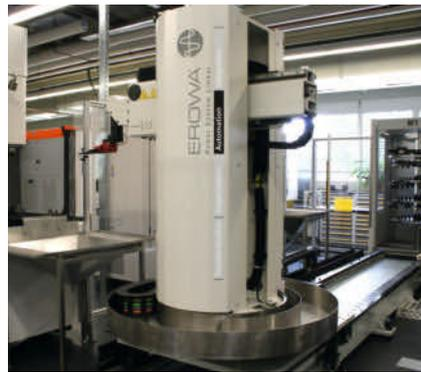
**Automation:** Das »Robot System linear« von Erowa steht an der Rückseite der Senkerodiermaschinen.
