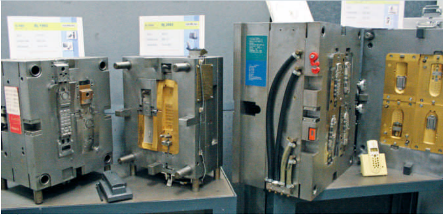
Im Wandel der Zeit: 17 Jahre liegen zwischen der links und der rechts abgebildeten Spritzgießform, die Erstellungszeit ist dabei von 107 auf 35 Arbeitstage gesunken.
