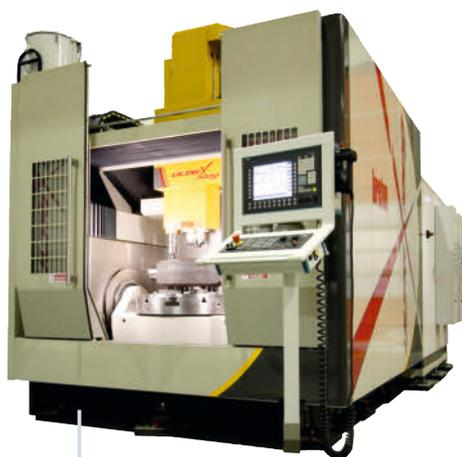
**Ultrix 1000 RT HD:** Die Maschine bearbeitet Bauteile bis zu einem Durchmesser von 1200 mm in Hochgeschwindigkeit.
