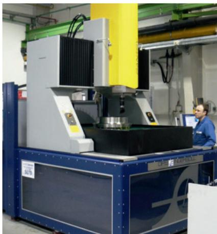
**Senkerodiermaschine:** Mit der Gantry 1200 lassen sich nicht nur große Werkstücke bearbeiten, sondern auch mehrere aufspannen, ohne ein bereits vorhandenes Werkstück vom Arbeitstisch holen zu müssen.
