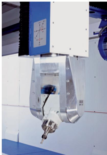
**Hochfrequenz-Frässpindel:** Ihr Gabelkopf hat einen Schwenkbereich von  $\pm 115^\circ$  in der A-Achse. Die vorgespannten Rollenumlaufungen sorgen für hohe Steifigkeit während der Bearbeitung.
