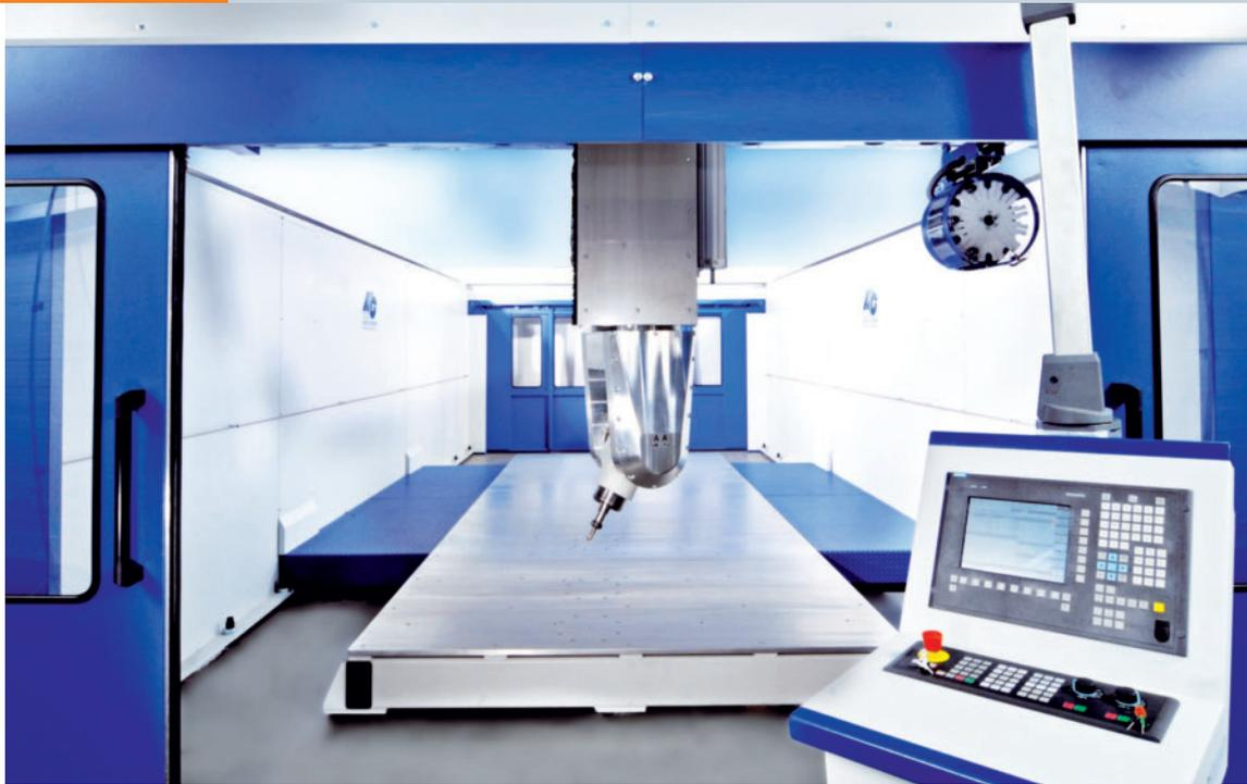
**Portalfräse:** Die fünfachsige G-S-F/M (60-25) eignet sich vom Prototypenbau bis hin zur Serienfertigung und soll vor allem im Modellbau eine sich schnell amortisierende Investition sein.
