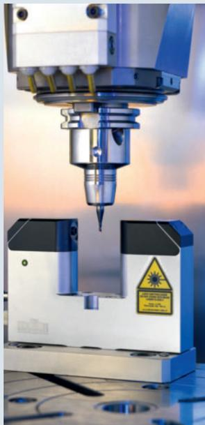
**Werkzeugmessung:** Um dem Bediener das Arbeiten zu erleichtern, kann der Laser Tool Setter selbst den höchsten Punkt eines Werkzeugs finden.
