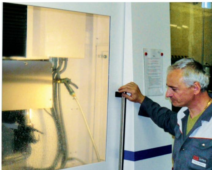
**Volleinhausung:** Diese ist bei der Schleifmaschine Vario etwas gewöhnungsbedürftig, aber aus gesundheitlicher Sicht notwendig. Die Volleinhausung verhindert das Entstehen eines allergenen Gemisches aus Schleifabtrag und Kühlmittel in der Raumluft.
