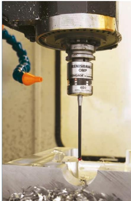
**Erkennungsdienst:** Messtaster wie der ›OMP400‹ ermitteln die Werkstückmaße direkt auf der Maschine.
