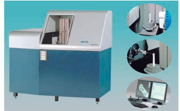
**Verdeckte Ermittlungen:** Das TomoScope ermöglicht die vollständige Erfassung aller Regel- und Freiformgeometrien am Werkstück in einem Messvorgang. Auch das Messen von Innengeometrien und nicht zugänglichen Merkmalen, zum Beispiel verdeckter Kanten oder Hinterschnitten, sind kein Problem.
