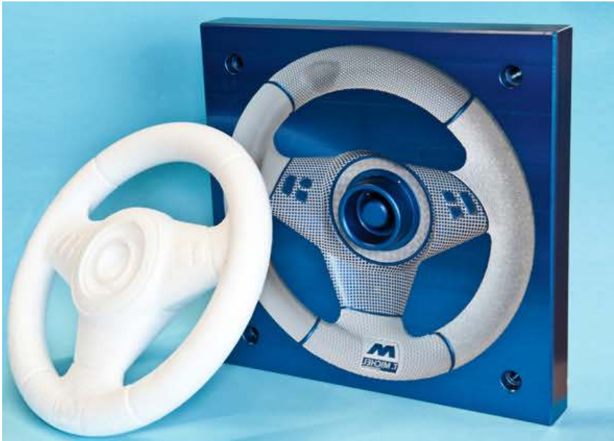
Waben, Netzgitter und Karos: Lenkrad-Schäumwerkzeug aus Aluminium und geschäumtes Muster mit unterschiedlichsten Oberflächenstrukturen.
