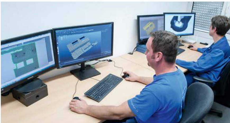
Konstruktion: Die Software zieht die Oberflächenstrukturen wie eine Gummihaut auf die Geometrie der Werkzeugform.
