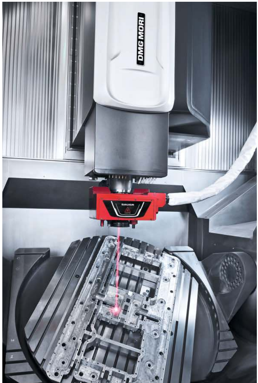
Hybridmaschine: Die Lasertec 125 Shape beherrscht das Fräsen und die Möglichkeit des direkten 5-Achs-Lasertexturierens von Formwerkzeugen. Das Verfahren ersetzt das sehr aufwendige und nicht umweltschonende Ätzen.
