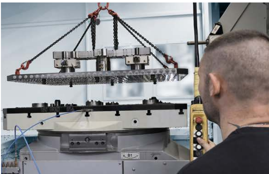
Wiederholgenauigkeit < 0,005 \text{ mm} : Die fertig bestückte Rasterplatte wird auf den Maschinentisch eingewechselt.
