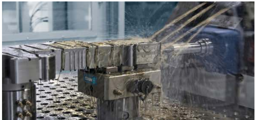
Freier Zugang auf fünf Seiten: Dank der Modulerhöhungen hat der Spindelkopf freien Zugang zum Werkstück.
