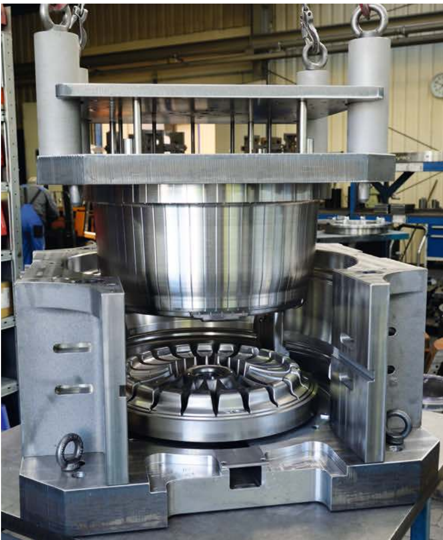
Kokille: ein bei Raskopf gefertigtes Niederdruckgusswerkzeug für Aluminiumfelgen.
