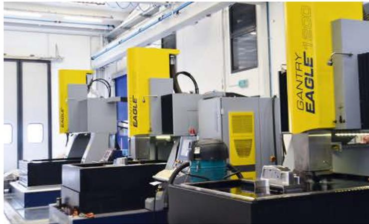
**Geht auch schräg:** Bei Elmann stehen drei Gantry-Eagle-Senkerodieranlagen von OPS Ingersoll in Linie. Die Elektroden sind auf FCS-Haltern montiert. Je nachdem, welche Aufspannung gewünscht ist, lässt sich das Werkstück auch schräg bearbeiten
