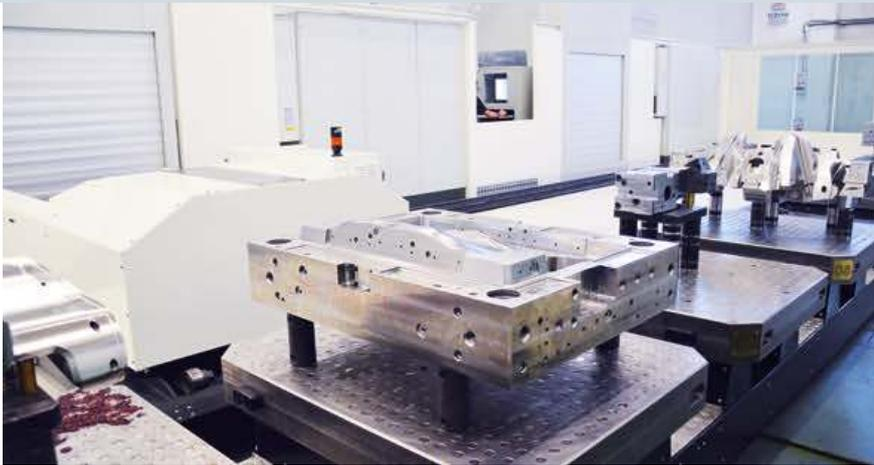
**Fräsaubahn:** Vier große Portalfräszentren werden von einem Flurfahrzeug bedient. Die Anlage wird von nur einem Mitarbeiter bedient – und arbeitet 24 Stunden, sieben Tage die Woche.
