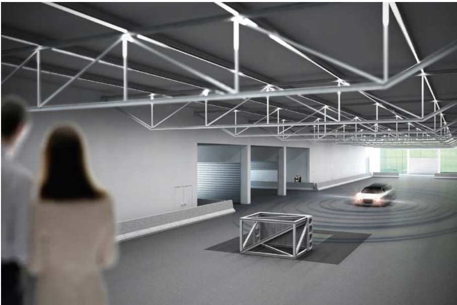
Bild 1: Bei einer Anlaufstrecke von 60 m werden in der Halle Geschwindigkeiten realisiert, wie sie vor allem im Stadtverkehr eine wichtige Rolle spielen. Müssen höhere Geschwindigkeiten erreicht werden, kann die Freiversuchsfläche genutzt werden. (© CARISSMA)
