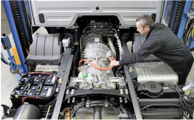
**Bild 1: Getriebe mit E-Motor. Der Drehstrom-Permanent-Magnet-Motor ist zwischen der Kupplung und dem automatisierten Getriebe angesiedelt.**
