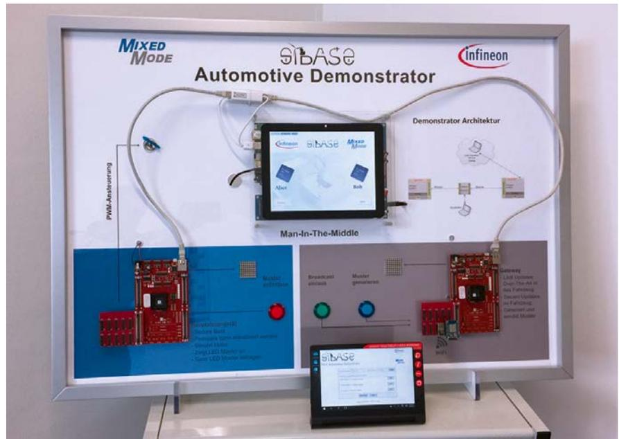
**Bild 1:** Auf dem SIBASE Automotive Demonstrator ist links das Steuergerät und rechts der Updatecomputer verbaut. In der Mitte hängt eine Visualisierungseinheit, die die On-Board-Kommunikation aufzeigt. Der Update-Computer ist über eine WLAN-Erweiterung an ein Windows-Tablet angebunden. (© Mixed Mode)
