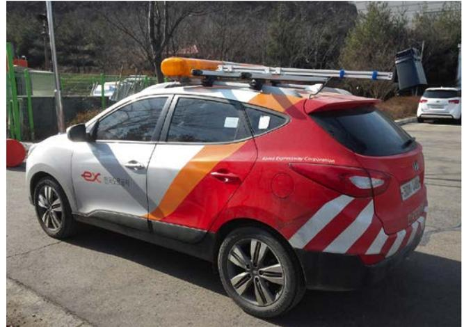
**Bild 2: In der Erprobung werden die Marwis-Sensoren noch in freier Lage und ein bis zwei Meter über Fahrbahnniveau angebracht.** (© Lufft)
