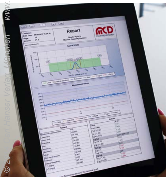
Bild 3: Screenshot von der Überprüfung der Klickgeräusche eines Blinkerrelais. Die Prüfung ist komplett mit der Scriptsprache erstellt und wertet das Ergebnis über eine Sollkurve aus. Das Fehlerbild zeigt das Fehlen des zweiten Klicks.
