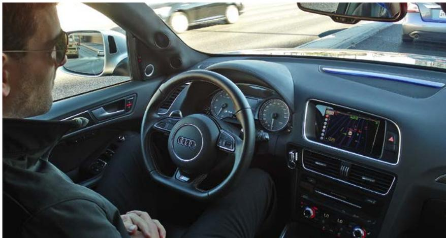
**Bild 2: Navigation, Wahrnehmung und Fahrzeugdaten werden auf dem Hauptbildschirm des Delphi-Fahrzeugs angezeigt. Der Fahrer und die Passagiere können Fußgänger, Ampeln, Fahrspuren, andere Fahrzeuge und allgemeine Objekte sehen, die in Echtzeit erkannt und identifiziert werden.**
