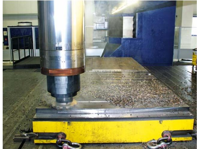
**5** Für hohe Aufmaßschwankungen und schwere Zerspanaufgaben: der zwölfzahnige 315-mm-Fräser Helitang mit besonders stabil ausgeführter tangentialer Klemmung (Bild: Hanser)
