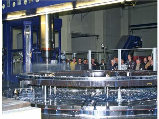
**3** Ran an das Teil: 22,5-mm-Bohren mit dem modularen Bohrsystem Sumocham IQ von Iscar, bestückt mit einer Bohrkopfgeometrie HCP-IQ für Bohrtiefen bis 12 x D ohne Pilotierung (Bild: Hanser)
