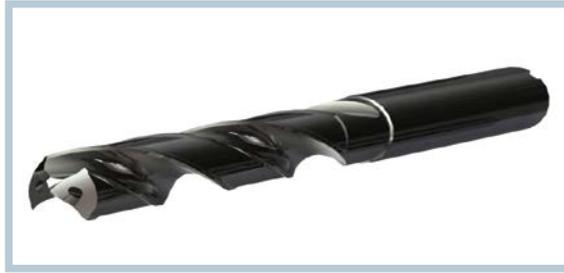
**2** Um eine optimale Spanbildung zu erreichen, hat dieser Bohrer RT 100 AL von Gühring einen Spitzenanschliff mit offener Ausspitzgeometrie. Angestrebt werden Top-Oberflächen im Bereich Ausspitzung und Freiflächen zur Verringerung von Aufbauschneiden
