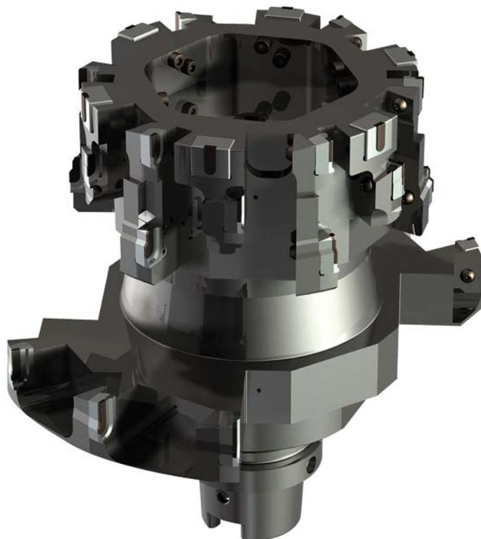
**1** Bei 280 mm Durchmesser wiegt dieses modulare Leichtbauwerkzeug zum Fertigbearbeiten der Hauptzugbohrungen von Getriebegehäusen nur 13,8 kg [Bild: Gühring]
