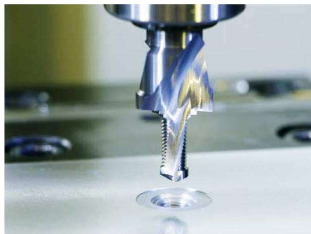
**4** Insgesamt sechs verschiedene Bearbeitungsschritte und daraus resultierend eine beachtliche Standmenge bewältigt dieser Bohrgewindefräser
