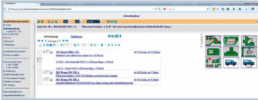
4 Die Arbeitsplanerstellung für eine Überwurfmutter und einen Anschweißstutzen stützt sich auf die verschiedenen Module zum Drehen und Fräsen (Bild: ADD)
