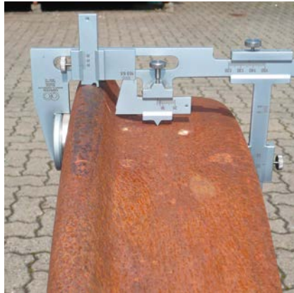
3 20 Prozent des Umsatzes bei Capecchi betreffen Schienenlehren für die Eisenbahn zum Testen der Waggonen und Lokomotiven (Bild: Capecchi)
