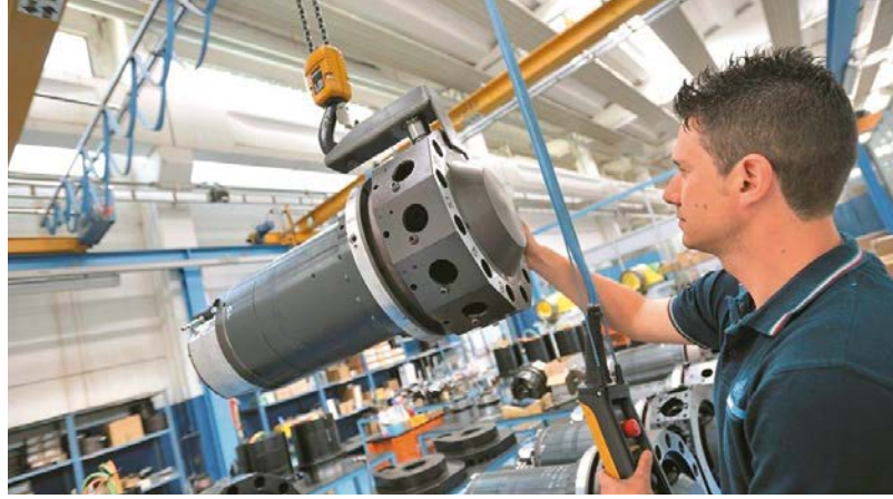
3 Ebenfalls Kernkompetenz der Inhouse-Fertigung: Famar-Revolver mit integriertem Direktantrieb und besonders hoher Leistungsentfaltung an den angetriebenen Werkzeugen (Bild: Famar)
