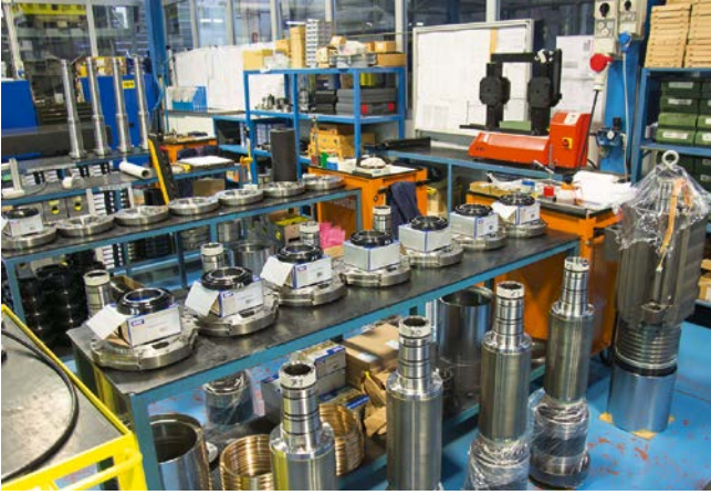
2 Spindelbau: Famar fertigt seine vielfältigen Spindelvarianten selber; vor der Montage muss jede Spindel ein umfangreiches Standard-Prüfprogramm durchlaufen (Bild: Hanser)
