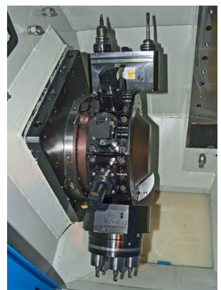
4 Verfahrensintegration im Sinne der Komplettbearbeitung: links eine kombinierte Drehfräs-Ausstattung; rechts ein Revolver mit Mehrspindelbohrkopf, einer Spezialität von Famar, die auf den hohen Leistungsdaten des Revolvers aufbaut (Bild: Hanser)
