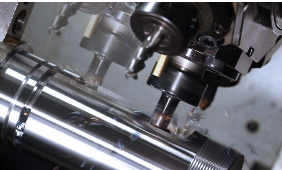
5 Durch das Monoblock-Flachbett, bestehend aus Meehanite-Guss, wird eine sehr hohe Steifigkeit und Dämpfung gewährt (Bild: Hommel Gruppe)
