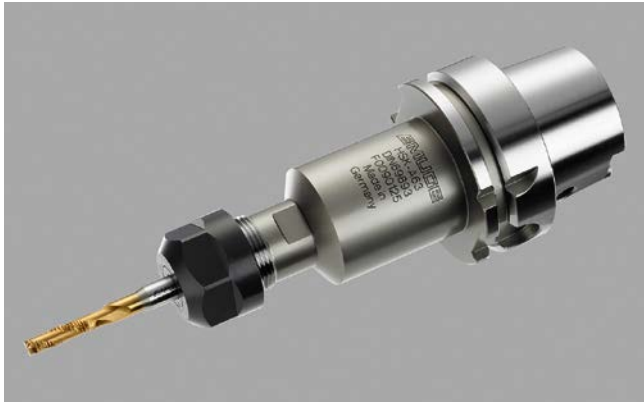
2 Das Punch-Tap-Gewindewerkzeug von Emuge-Franken hat statt eines durchgehenden Gewindeprofils am Umfang zwei um 180° versetzte Zahnreihen. Das dann mit einer Nut versehene Gewinde entsteht in 25 Prozent der üblichen Zeit (Bild: Emuge-Franken)
