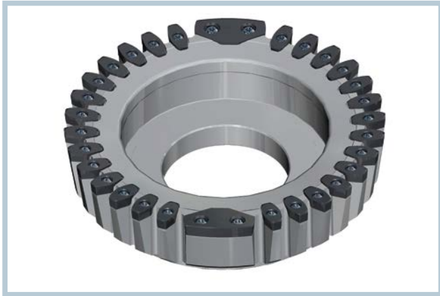
2 Volumenmodell des für QINT gestalteten Werkzeugs zum Wälzstoßen von Lamellenträgern. Gut erkennbar sind oben und unten die beiden Blockzähne, die die anderen 28 Zähne ergänzen und jeweils drei normale Zähne überbrücken (Bild: Ingersoll Werkzeuge)
