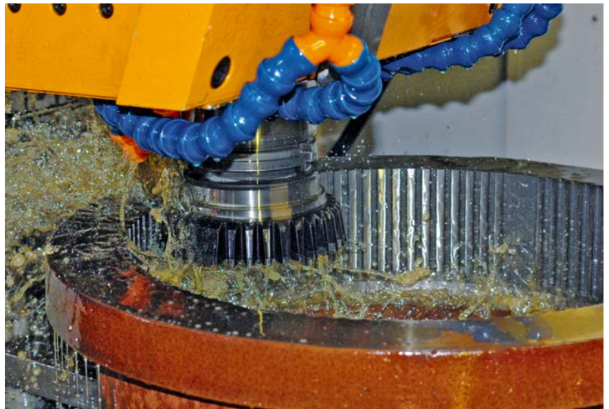
1 Das neue Wälzstoß-Werkzeug von Ingersoll beim Bearbeiten eines Lamellenträgers. Der erste Eindruck des Partners QINT war ein besonders ruhiger Lauf; dann ergaben sich beeindruckende Werte in puncto Hauptzeit und Standmenge (Bild: Ingersoll Werkzeuge)
