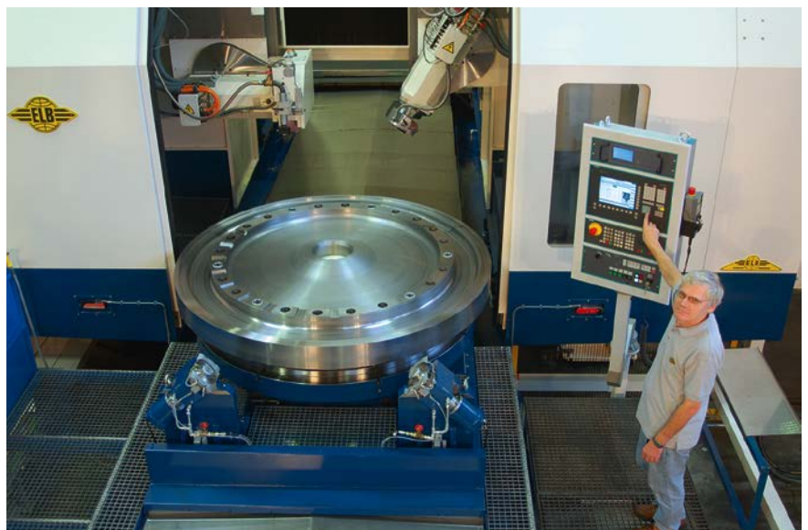
4 Die Kombi-Maschine gantryLine RT von Elb im Schleifmodus; eine Spindel ist als Schwenkspindel ausgeführt (Bild: Elb-Schliff)
